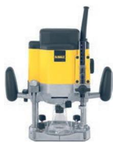
**Standardna oprema:** paralelna vodica sa preciznim postavljanjem, adapter za usisanje prašine, odvijač 22 mm, stezna čaura 12 mm.
