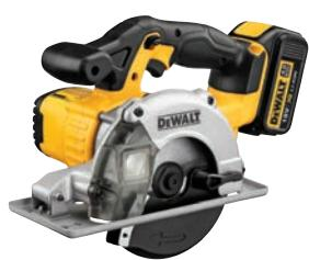
**Standardna oprema:** disk 165 mm od volfram karbida, šestougaoni odvijač za listove, usisni nastavak, višenaponski punjač XR, 2 akumulatora Li-Ion XR sa indikatorom stanja napunjenošću, čvrst transportni kofer.
