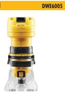
**Standardna oprema:** postolje u obliku slova D, stezna čaura 6 mm, kopirna vodica, vodica, montažni odvijač 17 mm, adapter za usisanje prašine.
